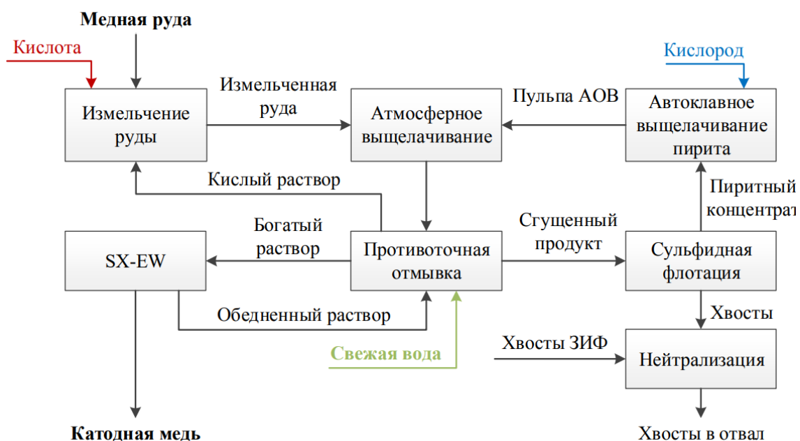
Рисунок 4 – Технологическая схема завода Seron
